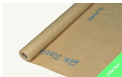
Papier kraft très résistant, monocouche. A utiliser comme pare-poussière sur les sols intermédiaires fermés et plans, sur les couches de glissement et similaires. Ne pas utiliser avec des matériaux en vrac aux arêtes vives.
