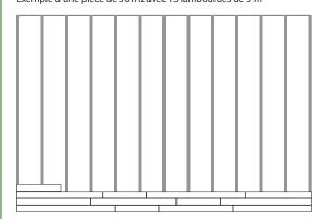
Bois conseillé : d'une densité suppérieure à celle du plancher (ou en bois de douglas) Section minimale: 40 x 60 mm à plat **Entraxe:** 50 cm maximum (de centre à centre) Pose à l'anglaise ou à joints perdus : chaque planche devra avoir au moins un point d'appui. Les
